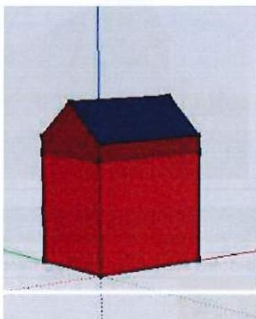
Le volume protégé d'un logement reprend tous les espaces du logement que l'on souhaite protéger des déperditions thermiques que ce soit vers l'extérieur, vers le sol ou encore des espaces non chauffés (cave, annexe, bâtiment mitoyen...). Il comprend au moins tous les locaux chauffés. Lorsqu'une paroi dispose d'un isolant thermique, elle délimite souvent le volume protégé.
